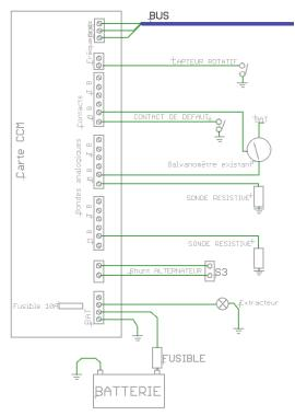
Le module CCM effectue des mesures par conversion analogique/numérique sur les capteurs traditionnels de pression et de température, utilisant les capteurs d'origine ou des sondes additionnelles. Il est possible de conserver les indicateurs analogiques traditionnels existants sans en perturber le fonctionnement. L'utilisation des sondes sans galvanomètre classique permet de réduire la consommation électrique d'un facteur 10.
